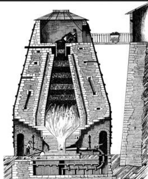
Furnal pentru obținerea fontei din cocs
